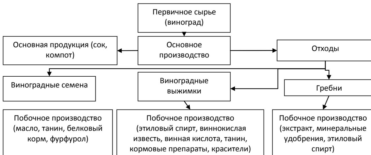
Рисунок 3 – Схема комплексной переработки винограда
